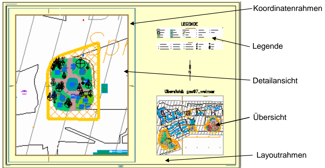
Beispiel für ein Plotlayout mit zwei Unterbildern und einer Legende in zwei Gruppen. Fachanwendung: Grünflächenkataster
